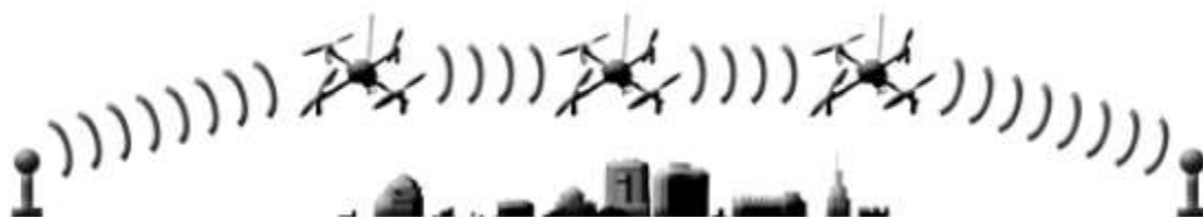
Рис. 2. Схематическое изображение сетевой структуры, с дополнительной одноранговой сетью [1]
